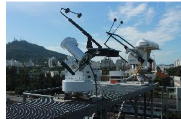
Medição da radiação solar na estação BSRN – FLO / WMO - NOAA
